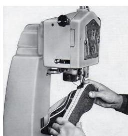
Lampada con trasformatore e riscaldamento
